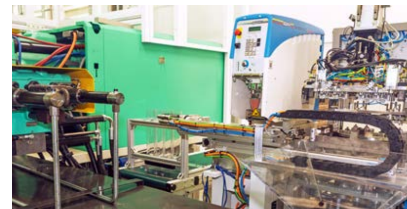
Eine 2K-Spritzgusszelle mit mehreren nachgelagerten Inline-Prozessen
