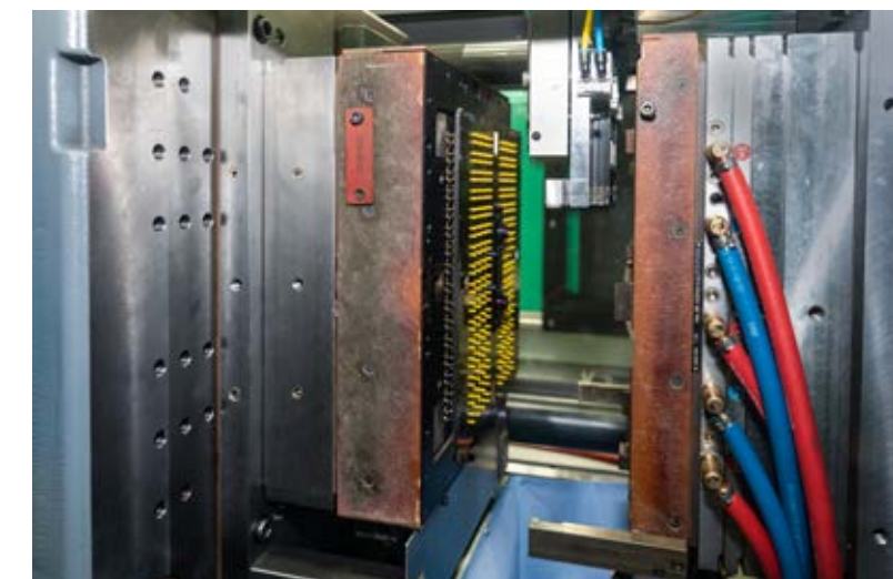
Spritzgusswerkzeug mit 256 Kavitäten für die Herstellung von Einzeladerdichtungen
