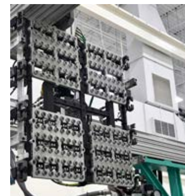
Das 96+96-Kavitäten-Entnahmesystem arbeitet präzise und schnell.
