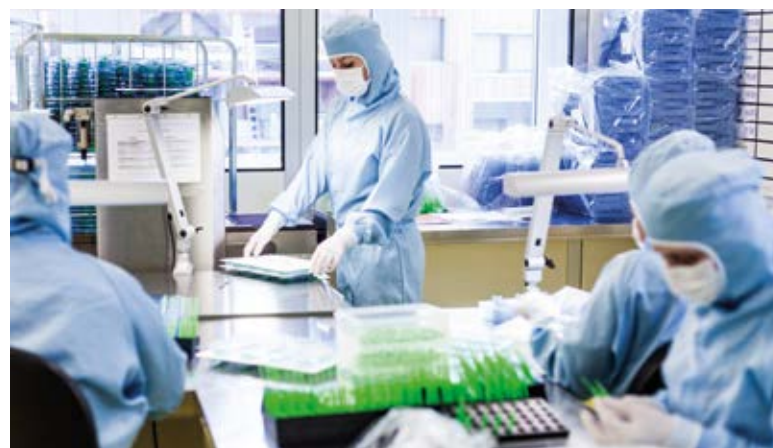
Produktion, Temperung und Verpackung - das alles passiert auf Wunsch im Reinraum.
